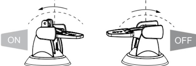
Le DOSATRON peut être équipé, dans sa partie haute, d'une fonction by-pass (matériel en option) :
