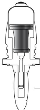
D'un moteur hydraulique volumétrique à piston entraînant :
